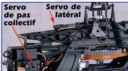
A droite, la commande du pas collectif sur EP Concept SR : une bague au pied du mât rotor est solidaire d'une tige courant dans une rainure, et cette tige agit directement sur le compensateur da pas.
