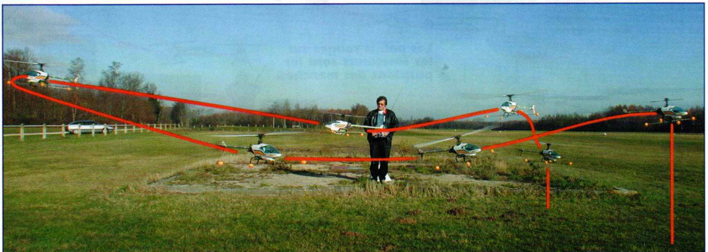
La même évolution vue en 3 dimensions, notez l'amplitude limitée à 5 m de chaque côté du pilote.
