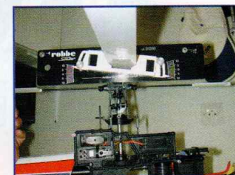
Le manche à mi-course, on maintient la barre de Bell perpendiculaire au mât rotor et on règle sur la radio de manière à avoir le dessous de l'incidencemètre parallèle à la barre de Bell.
