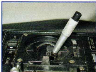
Réglage du pas mini (-3° pour cet exemple).
