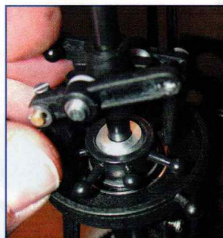
Sur ce plateau à trois points, la bague intérieure possède deux jeux de points d'ancrage, pour disposer de 2 sensibilités.
