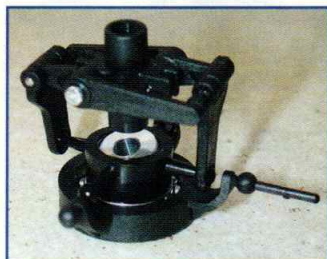
Un plateau cyclique surmonté du compensateur de pas.
