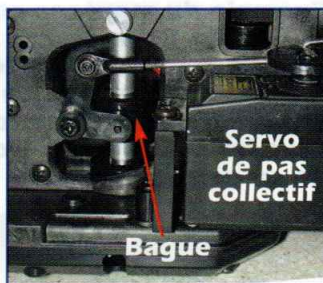
A droite, la commande du pas collectif sur EP Concept SR : une bague au pied du mât rotor est solidaire d'une tige courant dans une rainure, et cette tige agit directement sur le compensateur da pas.
