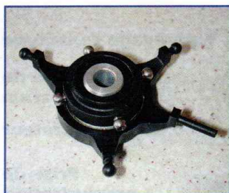
Un bel exemples de plateau 3 points à 120°. La réalisation est robuste, et ne craint pas les déformations.
