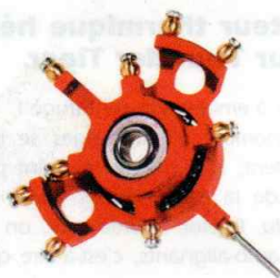
A droite, la commande du pas collectif sur EP Concept SR : une bague au pied du mât rotor est solidaire d'une tige courant dans une rainure, et cette tige agit directement sur le compensateur da pas.
