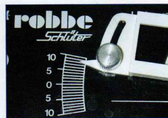
On règle ici l'incidencemètre pour un pas de stationnaire à +8°.
