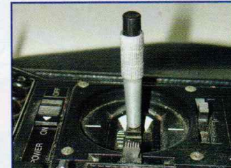
Le manche à mi-course, on maintient la barre de Bell perpendiculaire au mât rotor et on règle sur la radio de manière à avoir le dessous de l'incidencemètre parallèle à la barre de Bell.
