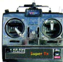
**Entrer en vrille : Profondeur plein cabré pour décrocher, direction en butée pour donner une dissymétrie de vitesse aux ailes. Résultat : une aile décroche alors que l'autre « vole », c'est parti pour la vrille.**
